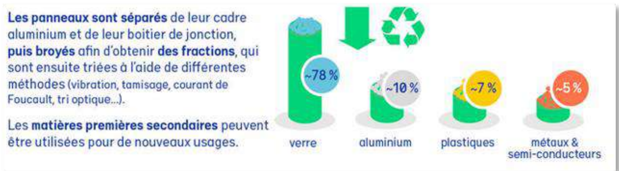
Figure 5 : Procédure de recyclage des panneaux (Source : SOREN)
